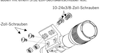
Zur Montage des ProTac® Rail Mount HL-X und der M-LOK-Halterung an der Schiene drehen Sie die T-Nut der M-LOK in die Montage-/Demontageposition. Positionieren Sie diese Baugruppe an der gewünschten Stelle an der Schiene. Ziehen Sie die 10-24x3/8-Zoll-Schrauben mit dem 1/8-Zoll-Sechskantschlüssel fest, um die T-Nut zu arretieren.
