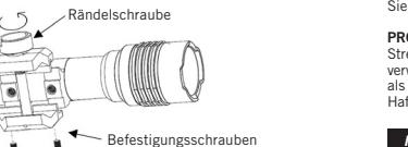
Bringen Sie die Bohrungen an der M-LOK®-Befestigung über die Bohrungen am ProTac® Rail Mount HL-X und ziehen Sie die 8-32x1/4-Zoll-Schrauben mit einem 3/32-Zoll-Sechskantschlüssel fest.
